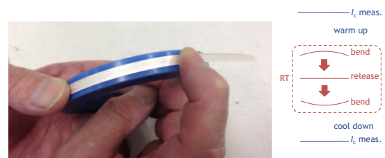
図 1. Bi 系高温超伝導線材の室温曲げ方法
