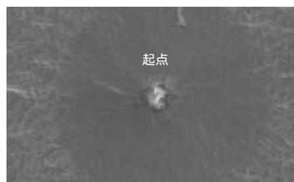
図5 ギガ疲労の起点を示す顕微鏡写真。内部の介在物が破壊の起点になっている。ギガ疲労の疲労起点は、黒い目に見えることから「フィッシュアイ」と呼ばれる
