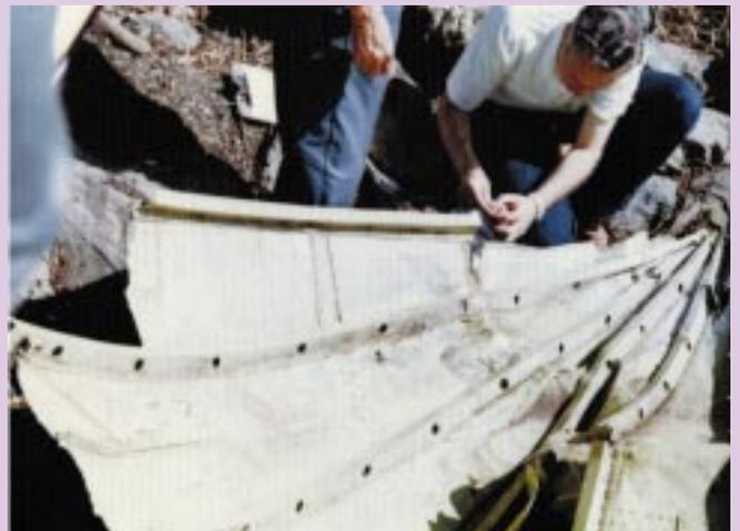
図B-1 日本航空ジャンボ機の疲労破壊した圧力隔壁
