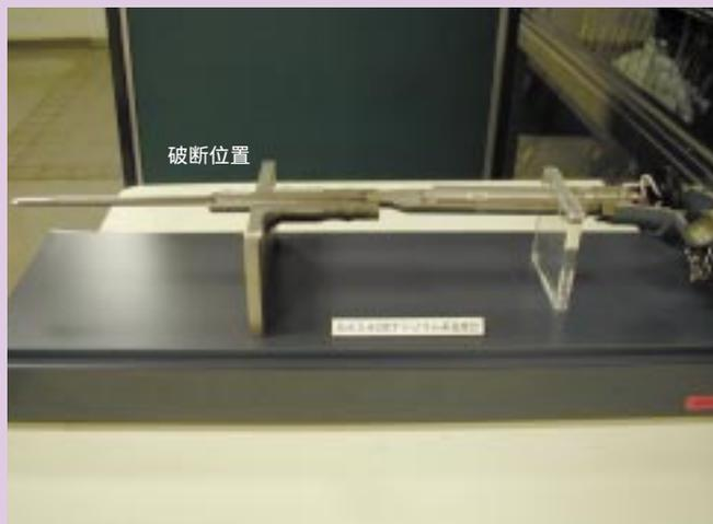
図B-3 高速増殖炉もんじゅで疲労破壊した温度計保護管のカットモデル
