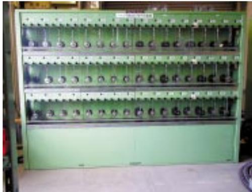
図9 通常の疲労試験装置のマルチ回転曲げ試験機。繰返し速さが1秒当たり100回(100Hz)。これまで多くの「疲労データシート」を産み出した疲労装置
