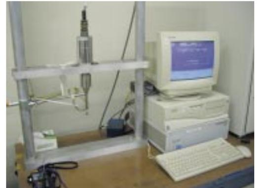
図10 開発した超音波疲労試験機。繰返し速さ1秒当たり2万回(20kHz)で、繰返し回数 $10^{10}$ 回の疲労試験を1週間で実施
