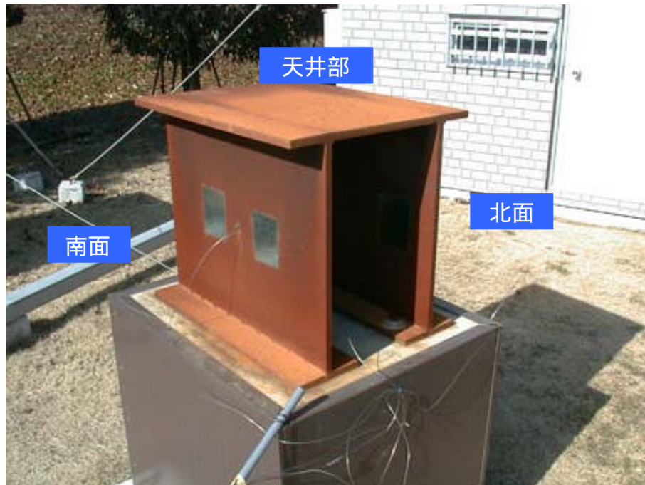
図2 構造物模擬試験体の外観 耐候性鋼 厚さ 15mm
