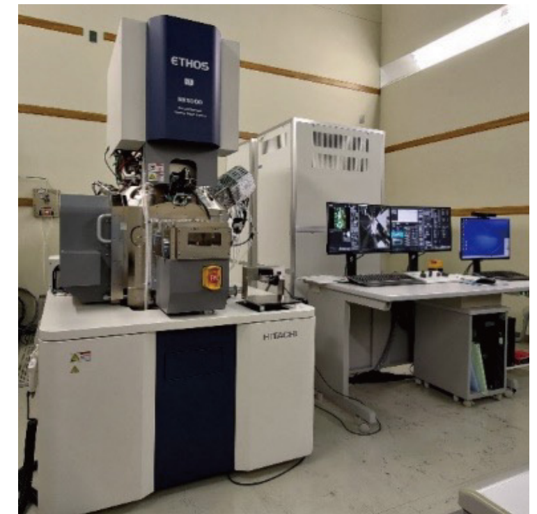
図1: TEM試料自動作製FIB-SEM複合装置 (Ethos NX5000)
