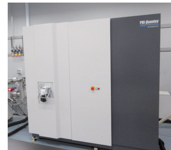
図1: 硬X線光電子分光分析装置 (HAX-PES/XPS)
