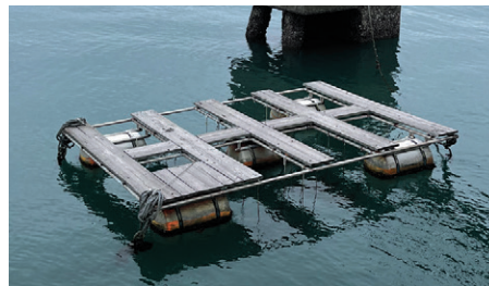
海洋での塗料の性能評価試験の様子。試験板を海水に浸漬し、1週間毎に海洋生物の付着を評価する。
