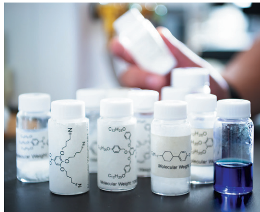
吉尾の真骨頂は、自己組織化で得られる最終構造を見越した分子設計の巧みさと、その合成技術にある。実験室には吉尾らが合成したイオン伝導性液晶分子が複数種類並ぶ。これら「パーツ」の作製を含め、10段階以上の工程を重ねて高分子の鎖を紡いでいく。
