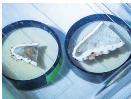
ハサミの断面図。硬質層と軟質層からなる複合構造だ。
