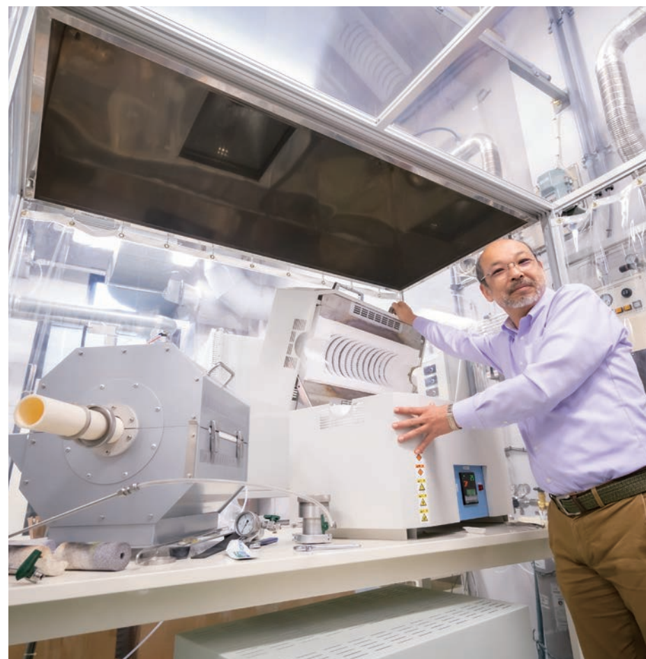
セラミックスを焼き固める電気炉。いつものように高温で焼いたにもかかわらずフワフワの粉に。
