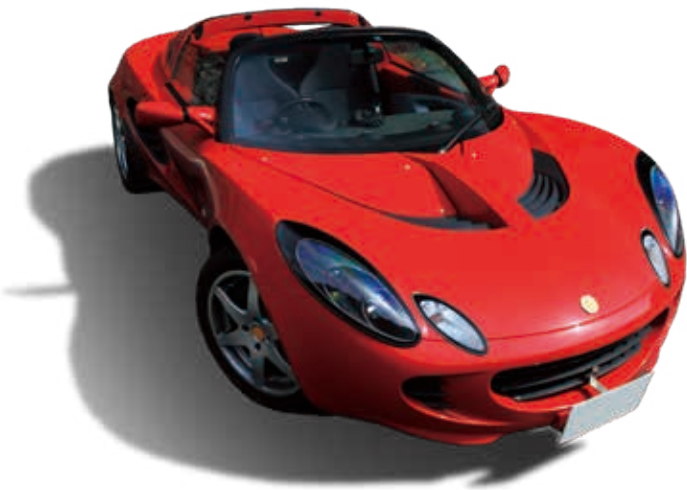
*ロータスエリーゼ 「イギリスのロータス社から1995年に誕生したロードスター型のスポーツカー。軽量化を目指してきたロータス社ならではの発想で、ボディを接着剤で接合するという斬新なアイデアで軽量化を実現し、話題になりました」(知京)
