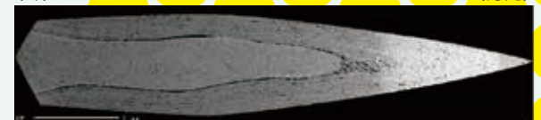
反射電子像観察でわかる日本刀の断面。刃となる先端部分がマルテンサイト組織。(提供: 日本電子(株) 塚本一徳氏、木村隆氏)
