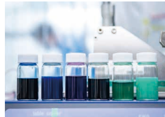
現在、開発中の銅インク。インクとでき上がった配線がすぐに酸化してしまうのを防ぐため、他の金属元素を添加して酸化しにくくするなど、試作を重ねている。含まれる元素や安定剤の種類によってその見た目はカラフルだ。
