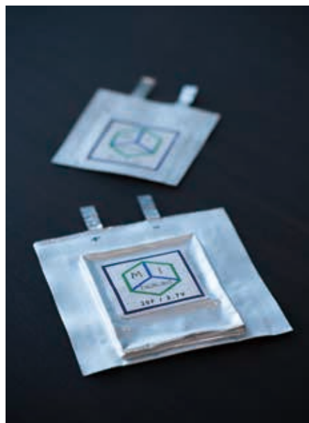
「ラミネート型」と呼ばれるシート状のグラフェンスーパーキャパシタ。成膜装置で作製した電極材料を同じ形に2枚切りだし、電解液と共にアルミバックに封入した。
