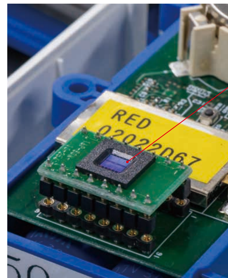
モイスチャーセンサの計測モジュール。 一辺5mmのシリコン半導体の上に2種類の電極が交互に50本ずつ並ぶ。2種類の電極をまたぐように水滴が付着すると、流れる電流の大きさにより、付着した水滴の量が分かるという仕組みだ。
