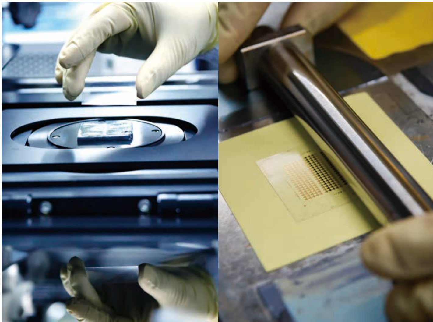
紫外線照射装置にフィルム状の基板と、マスクとなる金属製の版(p13右下写真)をセット。2つを重ねた上から紫外線を照射し、基板表面を部分的に親水化させる。 その後、基板にインクを塗布すると、親水性の部分にはインクが付着する一方で疎水性の部分はインクを弾き、微細なパターンが現れる。
