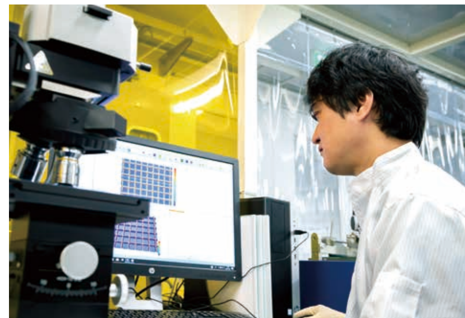
でき上がった微細な配線を三元顕微鏡でチェック。プリウエイズでは、カスタマーの開発した材料がプリントドエレクトロニクスに用いることができるかどうか、分析し評価する業務も行っている。
