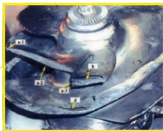
LE-7エンジンが取り付けられていたのは、ロケットの底部。引き上げられたエンジンの内部を調べると、燃料の液体水素を燃焼部へと送り込むために備えられたポンプの羽根が割れていた。（写真提供：JAXA）
