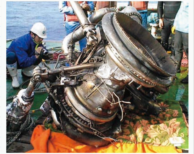
海の底から引き上げられたLE-7エンジン。 (写真提供: JAXA)
