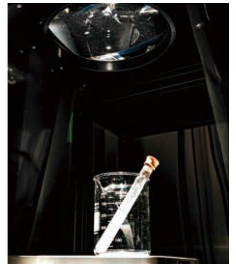
安息香酸の回収率を調べるため、酸処理したマガディアイト、トルエン、TiO 2 、アセトニトリルを試験管に入れ、疑似太陽光を照射した。
