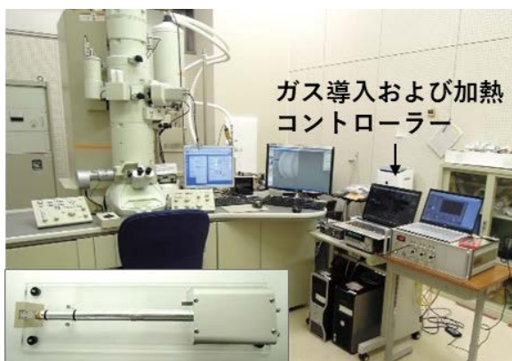
透過型電子顕微鏡 (TEM) 観察中のシステム全体と開発した試料ホルダー (左下)
