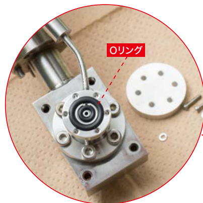
作業性・汎用性が高くなるよう開発を進める。上の写真は、新たに開発した試料ホルダー。試料を置く箇所に二重にしたOリング(環状パッキン)を配し、Oリングの間を差動排気することで、試料交換の簡便さと超高真空保持を両立させた。右は共同研究中の筑波大学大学院1年岩澤智也さん。
