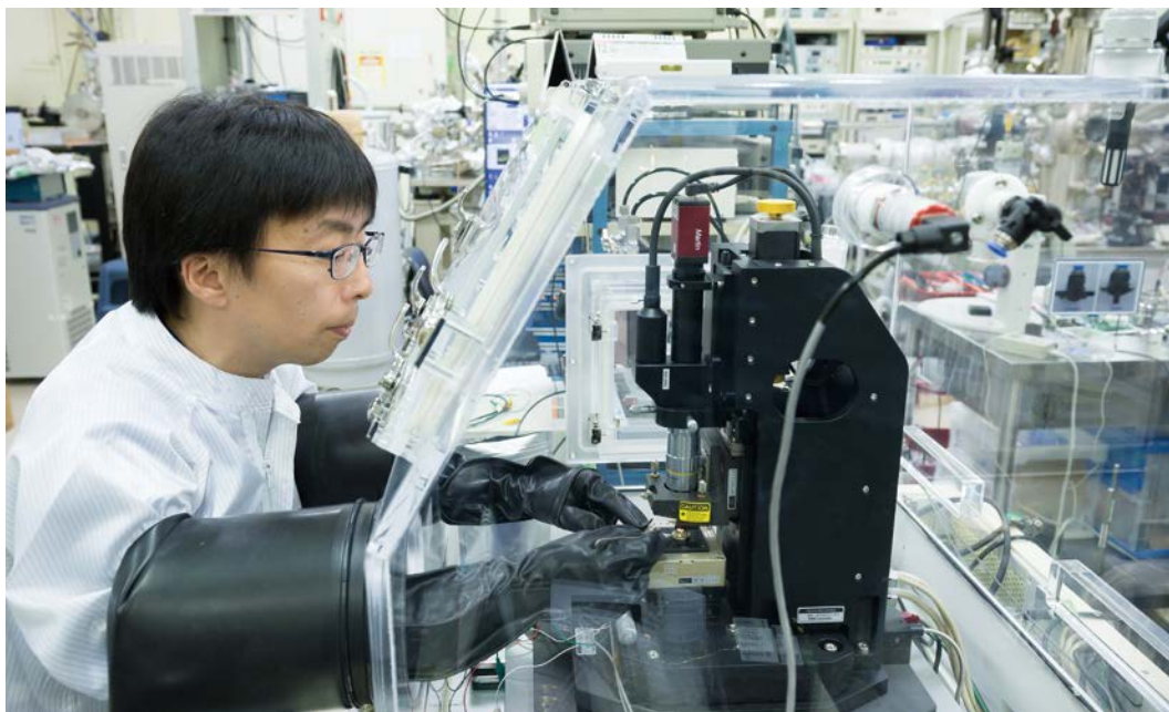
窒素ガスを充填すると共に、電池の電極取り付け作業や光の照射などを行うことが可能なKPFM計測装置をつくり上げた。(グローブボックス内部の様子はp2参照)
