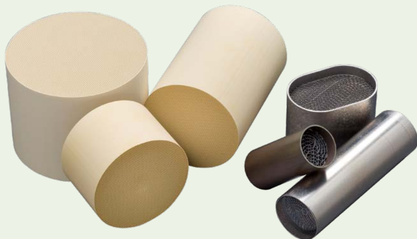
三井金属鉱業 機能材料研究所で開発した、自動車用の排ガス浄化用触媒。 左のセラミックス担体は4輪車用、右のメタル担体は2輪車用。 内側に、独自開発した高い浄化性能をもつ触媒層を塗布している。
