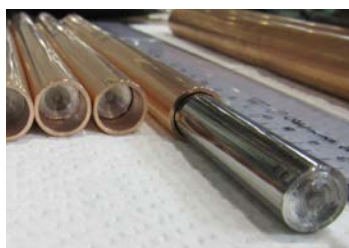
図3 NIMS でインハウス製造したジェリーロールピレット。Nb芯棒に0.1ミリ厚のNb箔と0.03ミリ厚のAl箔を重ね巻きして銅管に挿入する。これを静水圧押し出して細く加工し、束ねて多芯線材を作製する。
