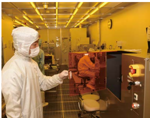
クリーンルーム内に設置された「高速マスクレス露光装置」を使用する竹内さん。フォトレジストを塗布した基板上にパターンを描画する際に用いるが、マスクを製作しない分だけ、コストと露光までの時間を削減することができる。
