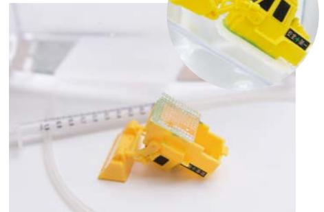
模型のブルドーザーの裏に、高分子材料を使って、ハムシの足の毛の形状を再現した機構をはりつけた。水中でスポイトを使い泡を蓄えさせるとガラス面にびたりとはりつく。
