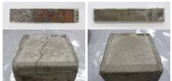
通常の炭素鋼(左)、開発した耐食鋼(右)を模擬鉄筋として用いたコンクリート供試体を伊良部大橋で2年間暴露試験した結果。炭素鋼鉄筋を用いたものは鉄筋腐食による体積膨張によりコンクリートにひび割れが入るが、耐食鋼を用いたものはひび割れが生じない。
