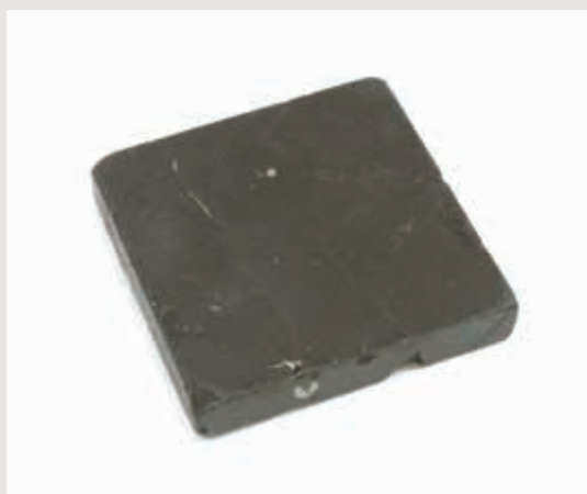
図2 ビスマス系高温超伝導体
