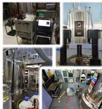
図1 桜地区に設置されている NMR 及び強磁場発生装置。
