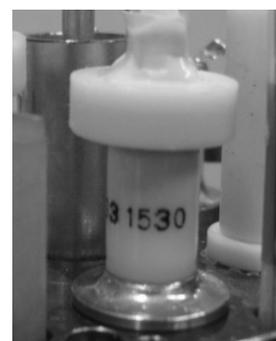
図2 本研究において開発した可変容量コンデンサ。
