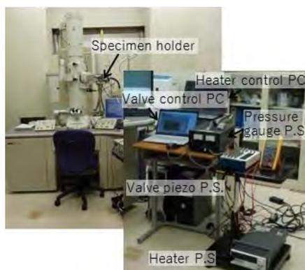
図1 実験で用いた試料ホルダーシステム
