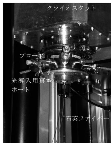
図 2 プローブのクライオスタットへの設置状況
