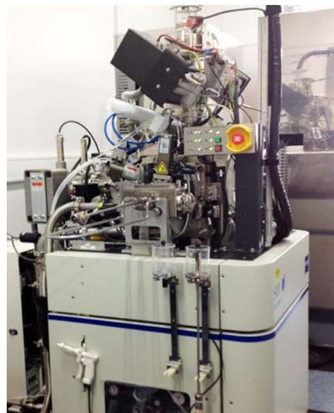
図 2.直交配置 FIB-SEM の模式図
