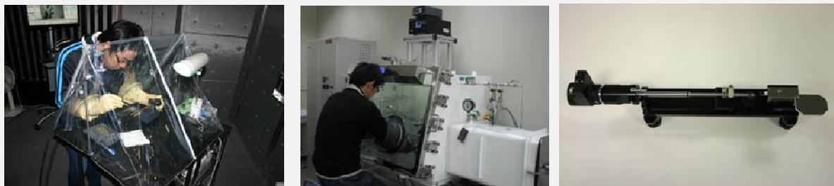
図 3-9 透過電子顕微鏡用の雰囲気制御試料搬送システムの一例
