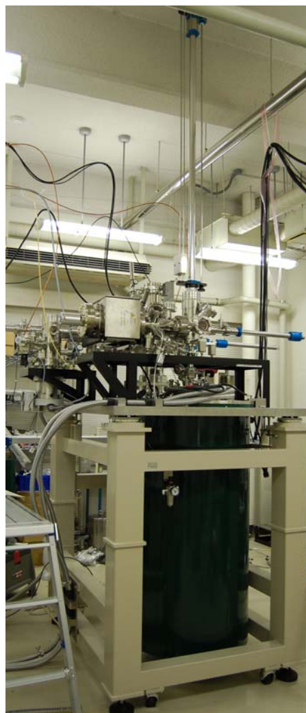
図 1 極低温・高磁場 STM 装置の外観写真。
