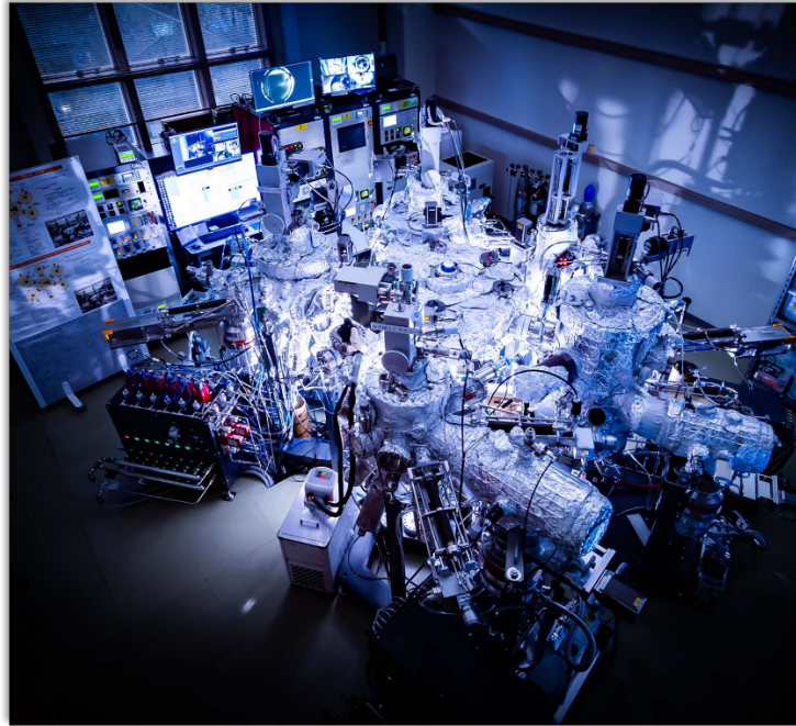
図5：薄膜作製に用いた高スループット成膜装置（写真：石川典人）。
