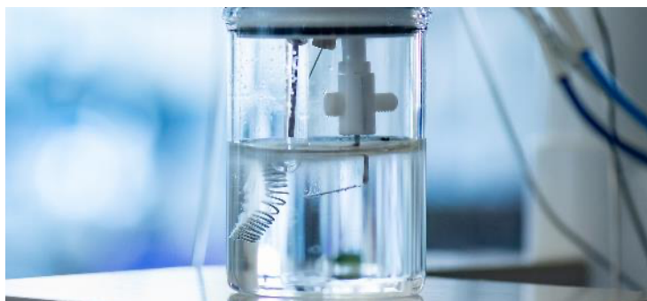
水の電気分解の様子。中央の曲がった構造の材料が今回対象とした電極。
