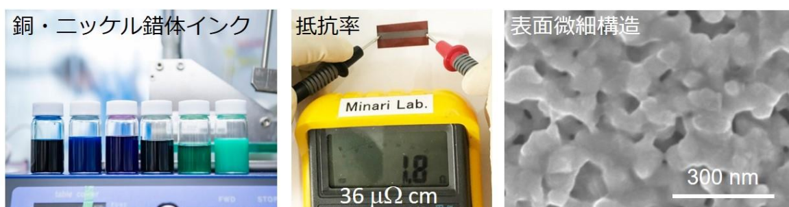
図1 銅およびニッケル錯体インクを混合することで、安定なコアシェル構造を形成する金属インクを安価に製造できる。
