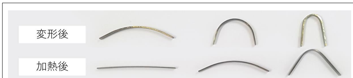
図2 \text{Cr}_{20}\text{Mn}_{20}\text{Fe}_{20}\text{Co}_{35}\text{Ni}_5 合金の形状記憶効果. 平板試料を室温で変形後、加熱した時の形状変化
