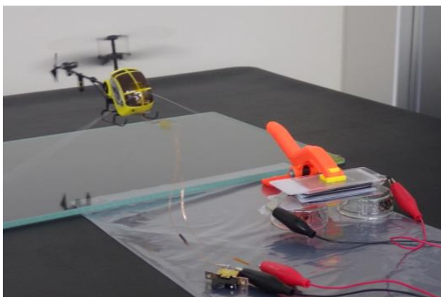
スタックタイプのリチウム空気電池によるおもちゃのヘリコプターの動作実証実験
