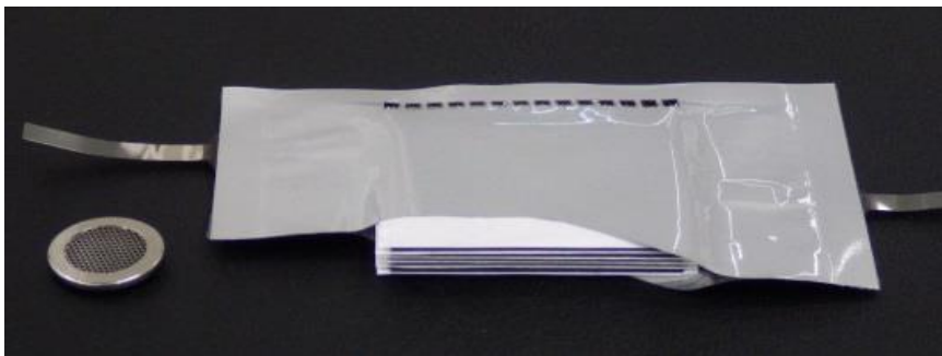
コインタイプ（左）とスタックタイプ（カットモデル、中央～右）のリチウム空気電池
