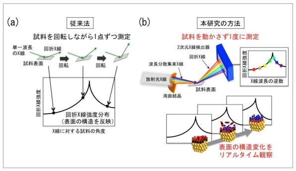
図1 (a)表面 X 線回折測定の従来法と(b) 本研究の方法
