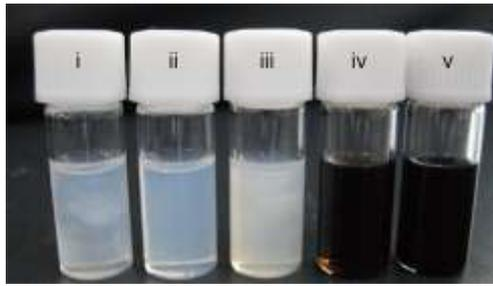
図1 ナノシートが分散したDMSOゾル。i~vは酸化チタンナノシート（サイズ大）、酸化チタンナノシート（サイズ小）、酸化ニオブナノシート、酸化グラフェン、還元型酸化グラフェン
