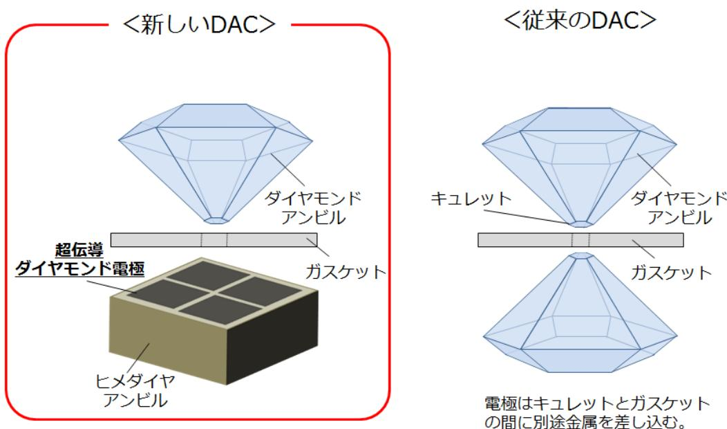
図1. ダイヤモンドアンビルの構造。
