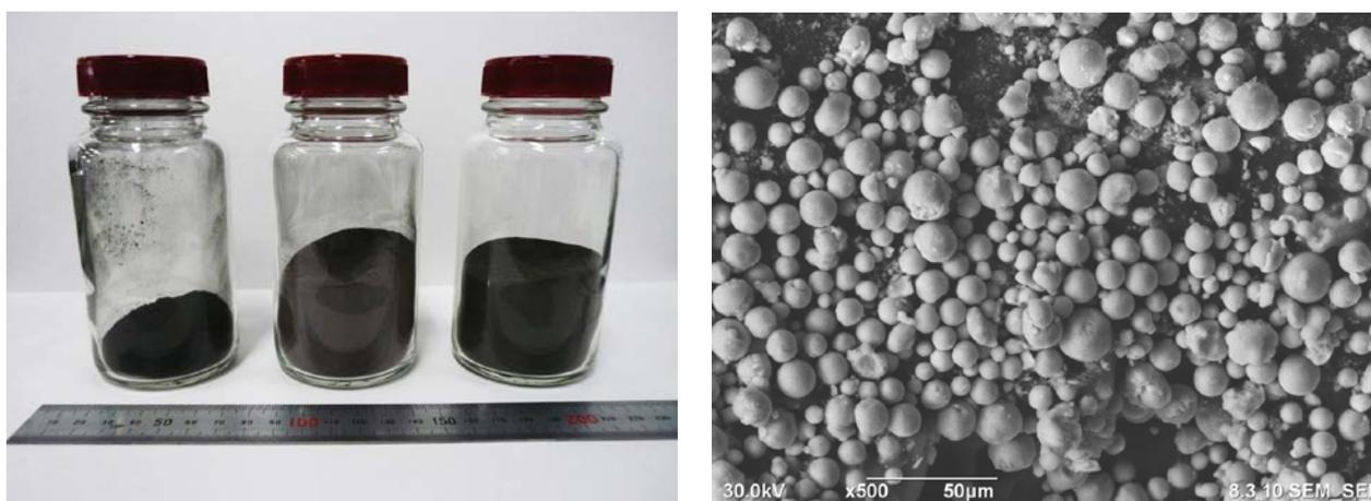
図6 (左) ガスアトマイズ法で作製した微粉末から触媒を大量作製したもの。合計で約400g。
