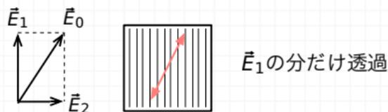
▶ 透過後～偏光の向き： $\vec{E}_1$ の向き，光の強度  $I : I \propto |\vec{E}_1|^2 < |\vec{E}_0|^2$
