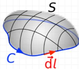
電場が磁場の時間変化に巻き付くように生じる
