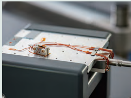
図1 桑田らが開発した、通電可能な試料ホルダー。モデルセルをステンレス板で挟んで台座にセットする。通電時の電場漏れを防ぐため、シールドをかぶせて測定を行う。装置に電極を引き込んでも気密性が下がらないよう、真空チャンバーの壁に「フィードスルー」という部品を組み込むなど、装置側にも徹底した改良を施した。
