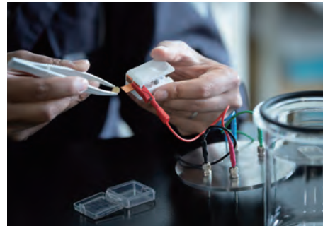
すべての焼結体についてインピーダンス測定を実施し、リチウムイオン伝導度を評価した。写真の試料は、測定のため固体電解質の表面に金電極を蒸着したものだ。
