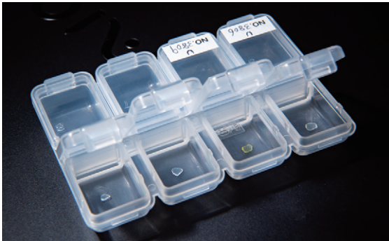
HPHT法で合成したダイヤモンド。用途に応じてNVセンタの密度を調整するため、炭素を溶かす金属溶媒の配合を調整するなど、最適な合成条件を探索している。窒素の含有量が多いほどダイヤモンドは黄みを帯びる。
