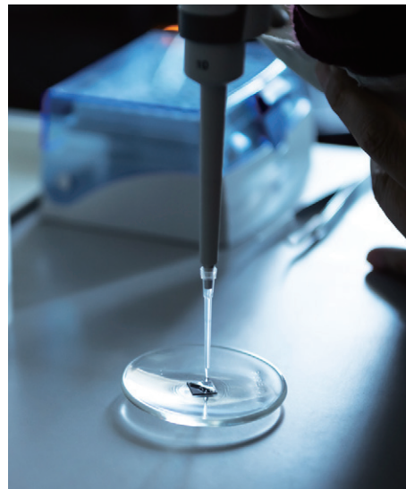
図2 前処理として、酸化物固体電解質の表面に凹凸処理を施した後、粉状の正極材料（粉体正極）を塗り付け、焼結助剤を滴下。約700℃で焼結した。これに負極材料（金属Li薄膜（箔）またはSi薄膜）を積層し集電極を取り付けたバルク型全固体電池は、低電流の場合には、結晶方位などを精密に制御した薄膜型全固体電池と同等の良好な電池特性を示した。
