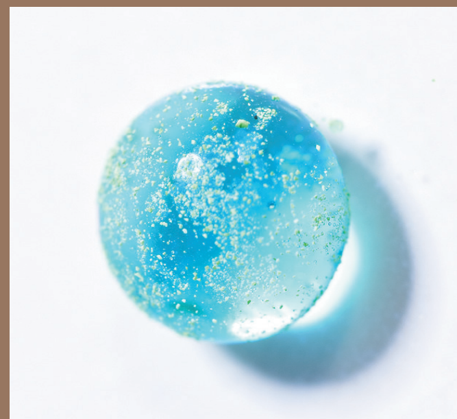
液滴を撥水性の粉末で被覆したカプセル化した「リキッドマール」
