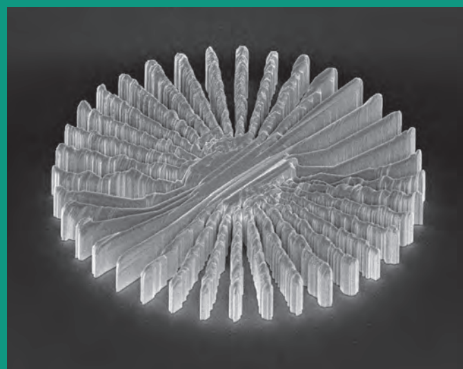
「選択成長」という手法で形成した「β型窒化ガリウム」の立体構造。
