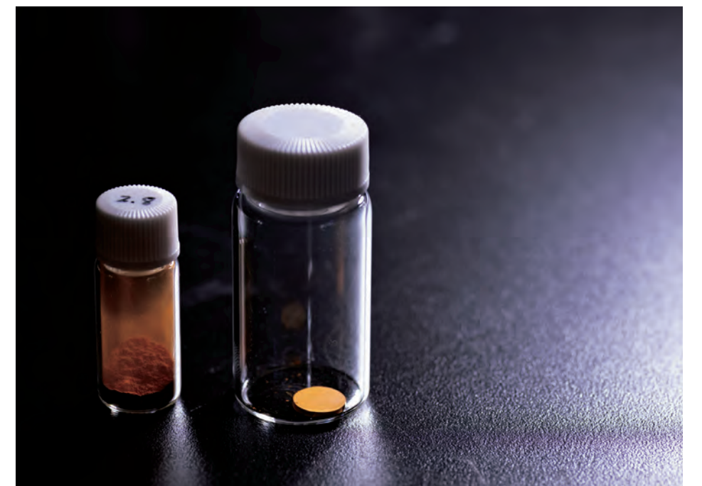
酸水素化ランタンの粉末(左)と、押し固めた焼結体(右)。酸化ランタンと水素化ランタンを混合、加熱することで合成できる。
