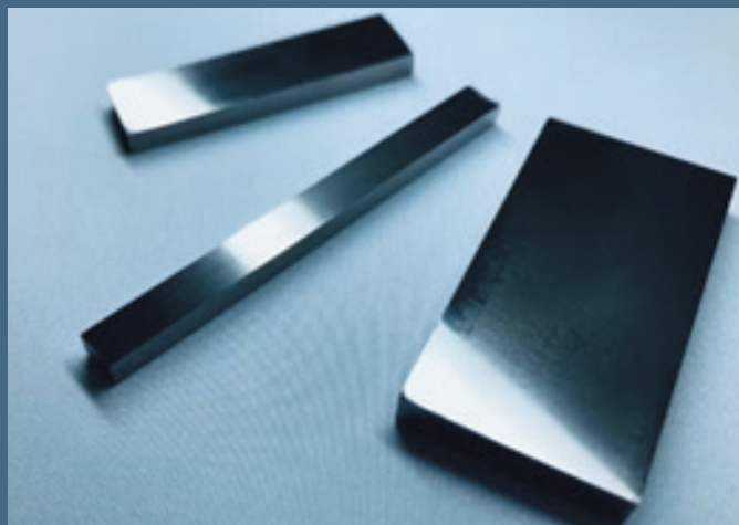
微細組織の制御で高性能化が進む「ジスプロシウムフリーネオジム磁石」
