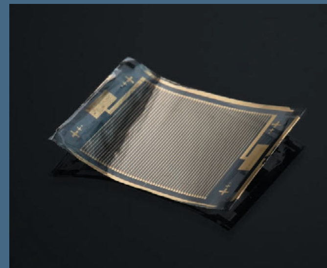
折り曲げ可能な「フレキシブル熱流センサ」 (P.10参照)
