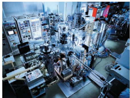
介川らが独自開発した自動成膜装置。4つの「スパッタリング室」と搬送ロボット室で構成され、スパッタ室の1つには電子線蒸着源も組み込まれている。あらかじめ設定したプログラムに基づき、搬送ロボットが基板を各種材料の成長に適した成膜装置に自動搬送していく仕組み。「例えば、微量の酸素ガスを送り込むために供給シャッターをごくわずかな時間だけ解放する、人手では難しいそうした作業を正確かつ再現性高く実施することがこの装置では可能です」(介川)
