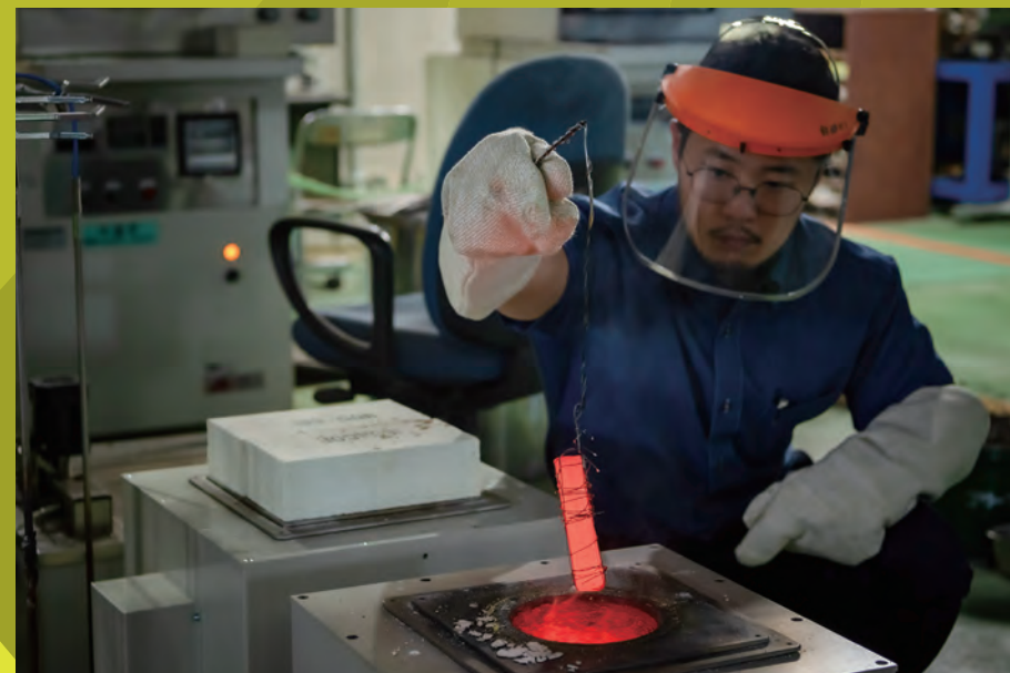
鉄鋼材料の組織をコントロールする上で一般的な、熱処理のプロセス。塩を溶解させた高温の「ソルトバス」に材料を入れ熱処理を行う。熱処理温度や冷却速度によって鉄鋼材料の特性は大きく変化する。
