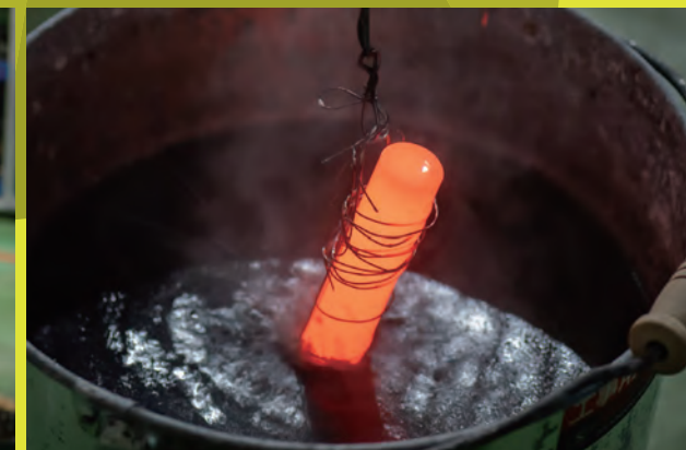
鉄鋼材料の組織をコントロールする上で一般的な、熱処理のプロセス。塩を溶解させた高温の「ソルトバス」に材料を入れ熱処理を行う。熱処理温度や冷却速度によって鉄鋼材料の特性は大きく変化する。
