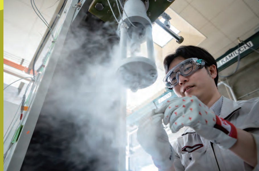
液体窒素温度下での「低ひずみ速度引張試験」の様子（破断した試験片はP.2写真）。
