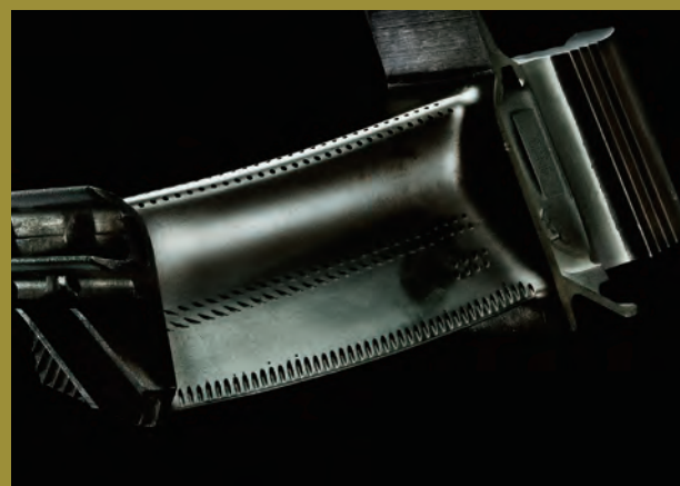
Ni基超耐熱合金製の航空機エンジンのタービン翼。(photo: Naohiro Tsukada)
