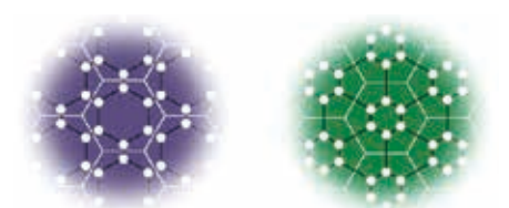
レーザー発振に用いる2種類の結晶の断面図（模式図）
