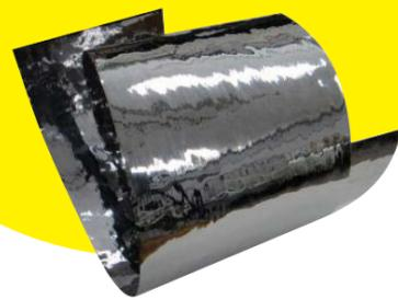
西村が開発した水素分離精製用V合金の箔。薄いほど水素の流量を多くできる。
