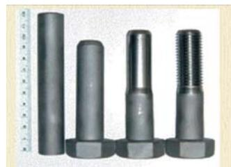
図3 1800MPa級プロトタイプ鋼によるM22ボルト
