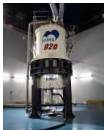
桜地区で順調に稼働中の 920 MHz 高分解能 NMR スペクトロメーター
