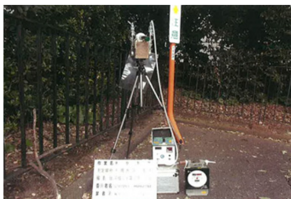
騒音測定中 (千現地区)
