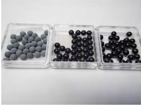
図1 ZnOコーティングを施したベアリングボール
