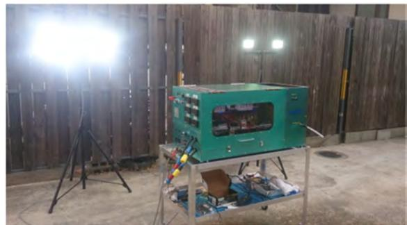
図5 ZnOコーティングベアリングを搭載した災害用小型ジェットエンジン発電機
