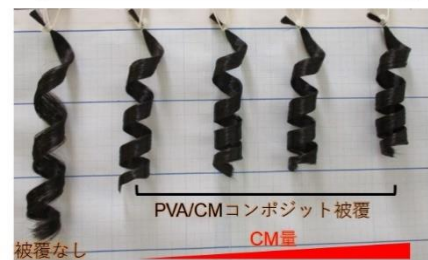
図. ポリビニルアルコール/セルロース微結晶 (PVA/CM) コンポジット材料による湿度応答性形状記憶ヘアスタイリング効果
