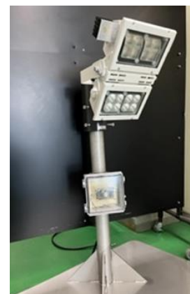
図2 IoT機器の試作機(人感センサーと小電力無線通信機器および照明器具排熱発電システム)
