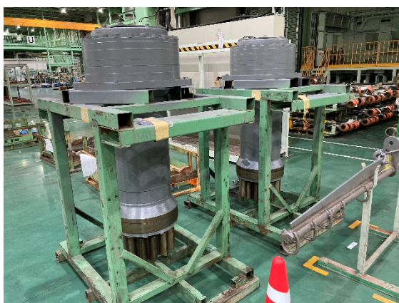
歯車が組み込まれている巡回減速機(左)と走行減速機(右)
