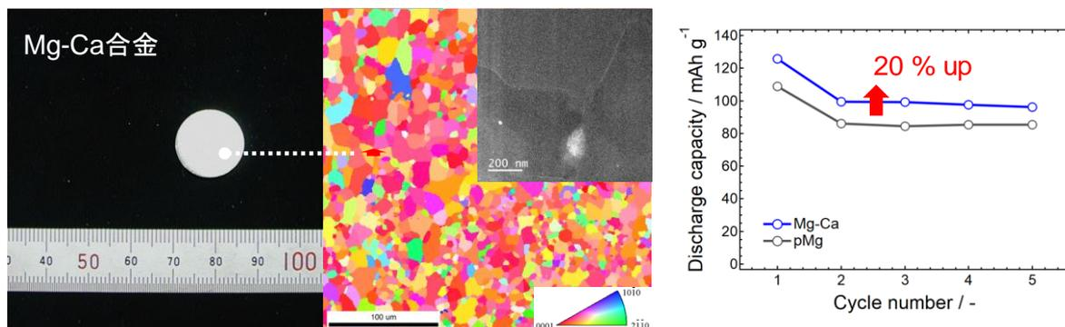
図1. (左) 開発 Mg-Ca 合金材の写真 (中央) 開発材の微細組織観察例 (右) pMg および Mg-Ca 材を負極に用いた電池の充放電試験結果。
